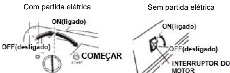
Volte a colocar a chave na posição ON quando o motor iniciar. Não use o arrancador mais de 5 segundos de cada vez. Se o motor não arranca, liberte o interruptor e aguarde 10 segundos antes de operar o arrancador novamente.
